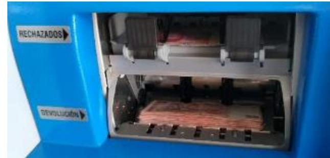
4) Si se decide hacer el depósito en la caja, los billetes bajan al bolsín de recaudación, dentro de la caja de seguridad
