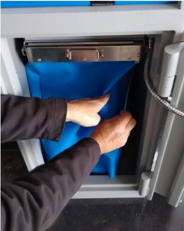
12) Se coloca la tapa en la ranura, se desliza hasta hacer fondo. En esa secuencia combinada actúan dos pestillos internos que traban la tapa y liberan el cajón metálico del bolsín.
